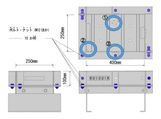
備考 1. ①~③は、模擬欠陥の位置を示す。 (①: 気泡、②: 角欠け、③: バリ)
