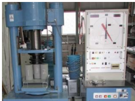
圧縮強度試験
